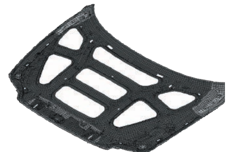
Bilindustrien har tatt i bruk forskningen på homogeniseringsteori for å gjøre bilene lettere og mer solide. Dette er avstivningen på et bilpanser.
